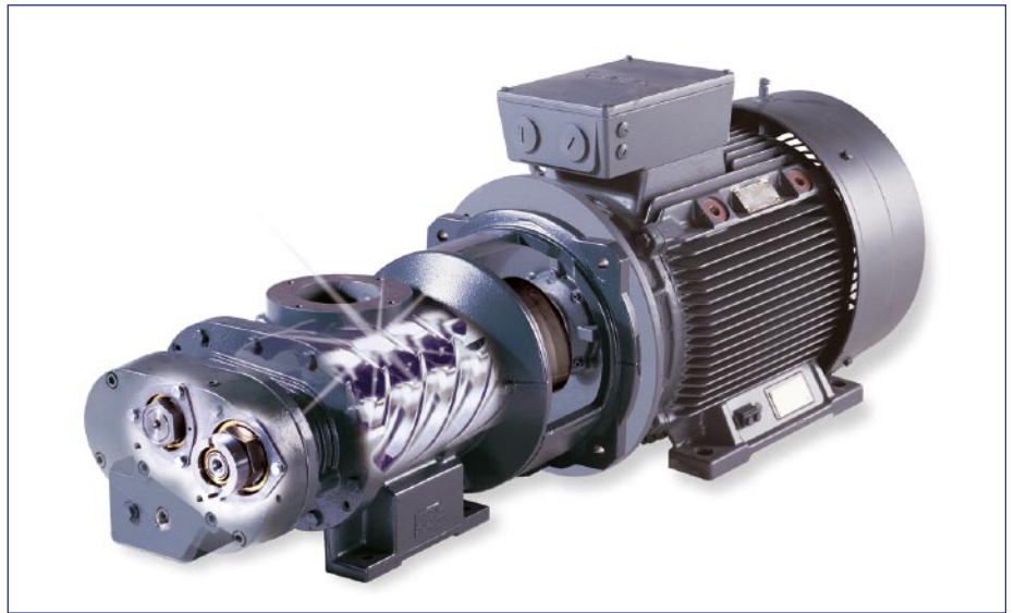
Abb. 2: Beim 1:1-Antrieb sind Kompressorblock und Elektromotor, die mit gleicher Drehzahl laufen, durch eine Kupplung verbunden. Dieser Antrieb arbeitet völlig ohne die Übertragungsverluste, die bei der Getriebebauweise unvermeidlich sind. Kompressorblock und Antriebsmotor bilden mit der Kupplung und dem stabilen Kupplungsflansch ein langlebige, wartungsarmes Aggregat.
