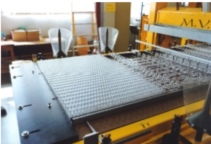
Neben Druckluft kommt bei der Handhabung, dem Transport und der Verpackung der Glasbehälter auch Vakuum zum Einsatz.
