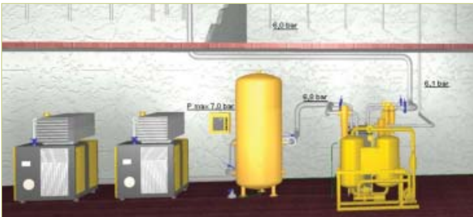
Die Analyse, die unter anderem die Differenzdrücke im Druckluftnetz berechnet, behandelt die untersuchte Druckluftanlage stets als Gesamtsystem.
