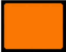
Abbildung 4-11: Muster einer Warntafel für Gefahrgut, anzubringen bei Transporten über 1.000 Punkte
