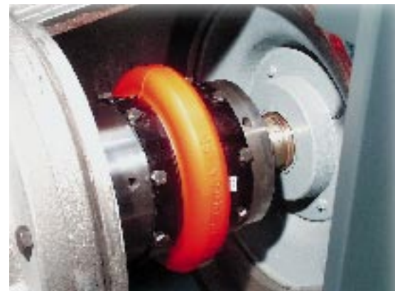
Bild 2: Bei einem echten Eins-zu-eins-Direktantrieb befindet sich zwischen Antriebsmotor und Kompressorblock lediglich eine Kupplung. Deshalb gibt es keine Übertragungsverluste zwischen den genannten Komponenten.
