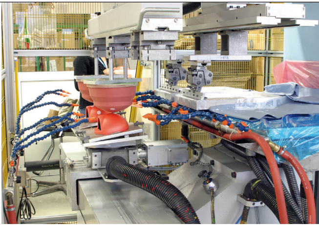
In der Tampondruckmaschine erhält das Fliegenpilzdach der „Osterhasenschule“ seine weißen Punkte. (Bild: Geobra Brandstätter)
