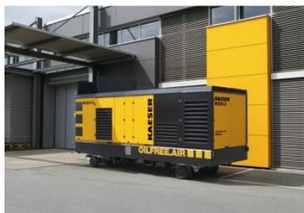
Mobiles Kraftpaket für große Vorhaben: Der neue M 500-2 von Kaeser Kompressoren erzeugt abgasarm saubere Druckluft mit Liefermengen zwischen 38 m<sup>3</sup>/min (10,3 bar) und 45,8 m<sup>3</sup>/min (6,9 bar).
