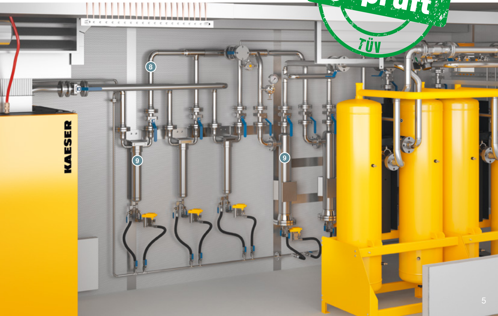
Container 3D Planung Filter und Adsorptionstrockner Verrohrung
