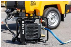
Dank des Nachkühlers liefert der M20 auch kühle und kondensatfreie Druckluft.
